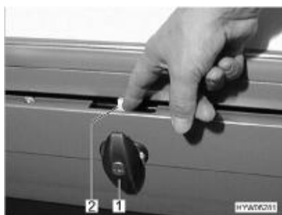
Afb. 47 Vergrendelingsknop aan de schuiflade onder de vloer
