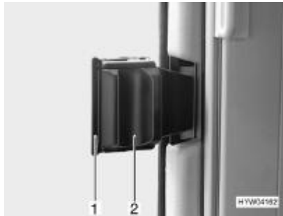
Afb. 48 Schuifraam met schuifvergrendeling
