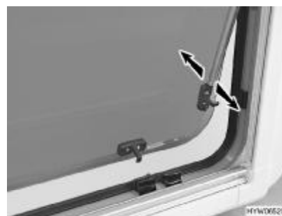
Afb. 54 Uitzetbaar raam met automatische uitzetters
