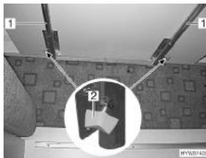
Afb. 72 Hangtafel, vergrendeling van het schuifblad
