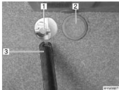
Afb. 261 Opening voor kabellier
