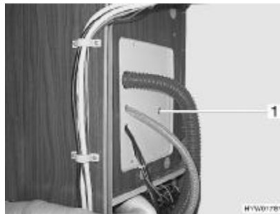
Afb. 154 Zekering van het toilet met fecaliëntank
