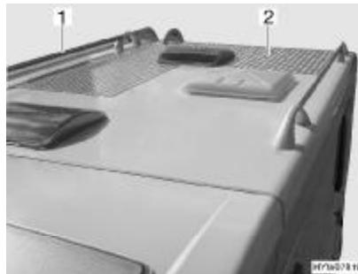
Afb. 1 Dakreling en bordes
