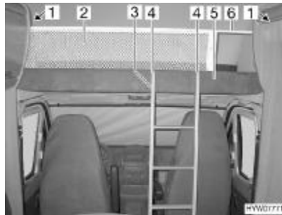
Afb. 95 Alkooft met bedladder en aangebracht veiligheidsnet
