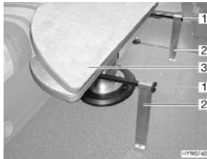
Afb. 79 Ombouw tot bed-onderstel
