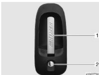
Afb. 36 Deurslot ingangsdeur, buiten
