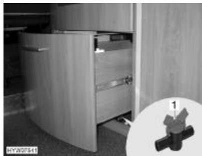
Afb. 218 Aftapkraan onder het keukensblok
